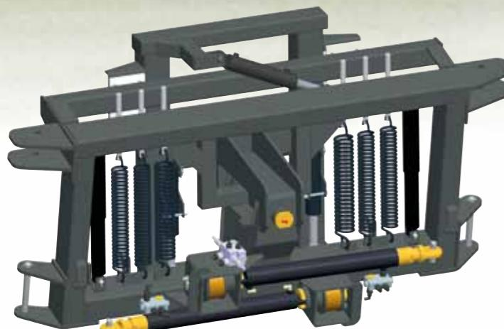
La rampe est équipée d'un dispositif anti-fouettement indépendant bras par bras. Ce système permet d'amortir le fouetttement horizontal lors des phases d'accélération et de freinage afin de préserver la structure de rampe.
