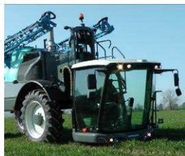
Le RAPTOR FC est équipé d'une cabine Grand Confort montée sur relevage avec suspension par boules d'azote. La vue panoramique offerte à l'opérateur, au travail comme sur route, rend la conduite plus agréable.
